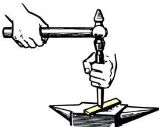
Рис. 69. Рубка полосового металла
